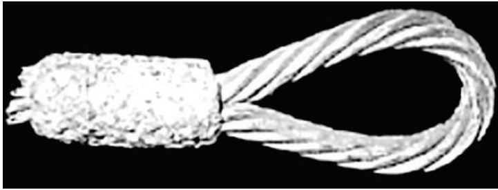
תמונה 2 משמאל: נוק פיזי לשרוול האלומיניום; מימין: שרוול מקושש
