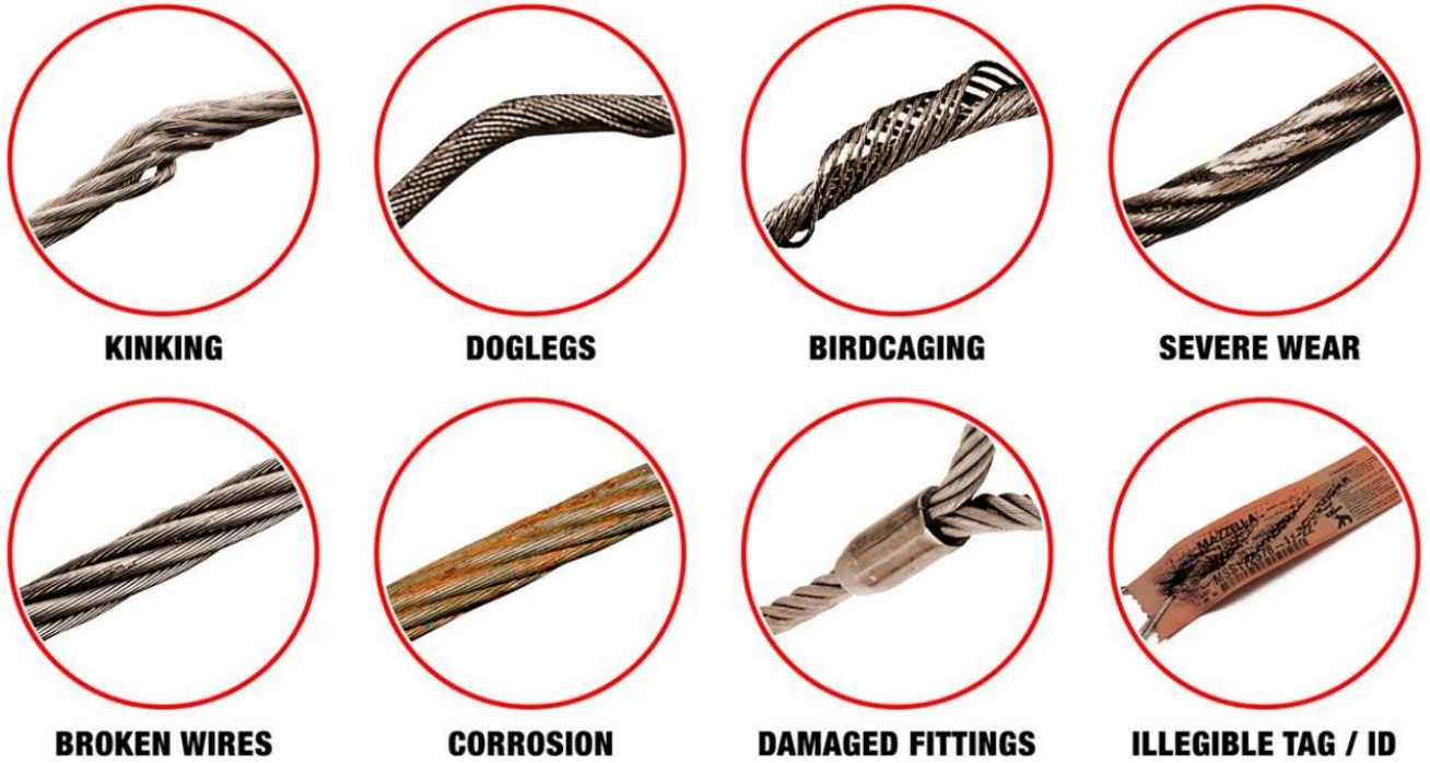
איור 14 נזקי כבל פלדה אופייניים
